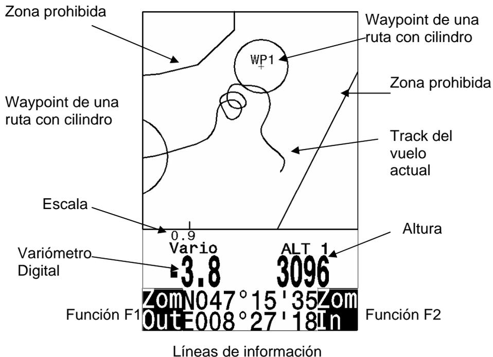
La ruta de vuelos grabados también puede ser mostrada en pantalla y vista. El análisis de vuelo se realiza presionando F1 a en la pantalla de la función "Show Map". La ruta de vuelo mediante una pantalla con escala optimizada es mostrada en pantalla. (El norte es localizado en la parte superior) Adicionalmente, los waypoints almacenados son plotados con una cruz y su nombre. La escala del mapa es mostrada también. La gráfica ahora puede cambiarse como sigue:
